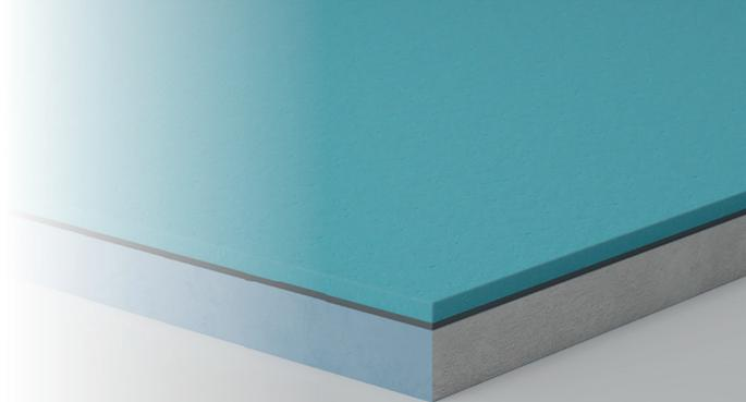
Soundboard hyperacoustique est une solution ultra mince et acoustique pour atténuer les bruits aériens. La mousse de cellules fermées réduit les vibrations, la plaque de plâtre phonique et le vinyle chargé en masse réduisent la transmission sonore aéroportée, principe de masse ressort masse.
