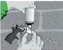
3. Secouer énergiquement l'aérosol pendant environ 20 secondes avant l'utilisation et après chaque interruption.
